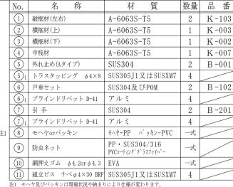
アルミ押出し材の表面処理は、JIS H 8602に規定する 陽極酸化複合皮膜仕様とし
